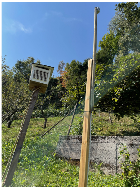
Slika 8: Postavitev Microsferics detektorja na travniku.
