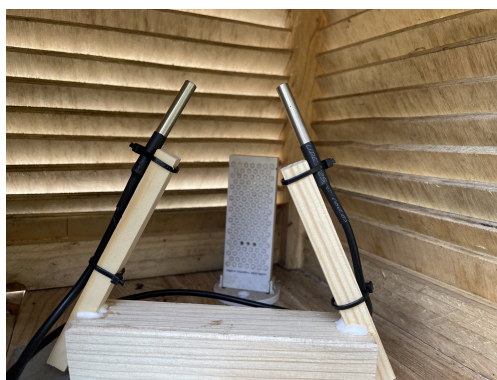
Slika 2: Dodatna temperaturna senzorja v vremenski hiški.
