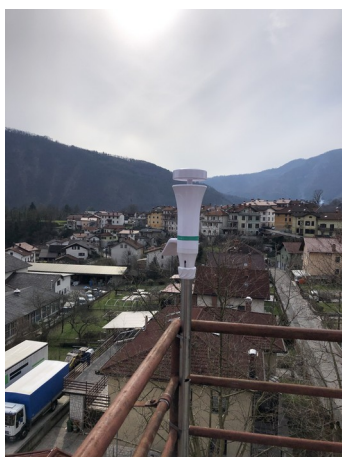
Ilustracija 4: Vetromer na gasilskem stolpu.
