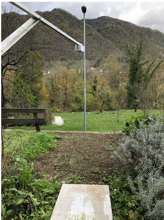
Ilustracija 3: Senzor za merjenje debeline snežne odeje.
