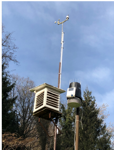
Slika 2: Davis in ostale postaje, nameščene v vremenski hiški.
