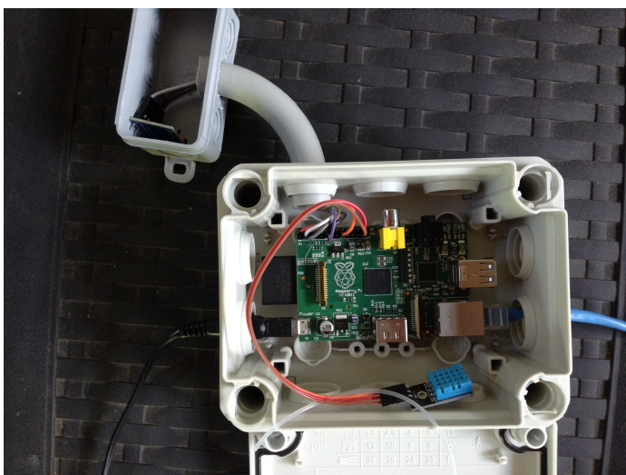
Ilustracija 8: Raspberry Pi + detektor AS3935.
